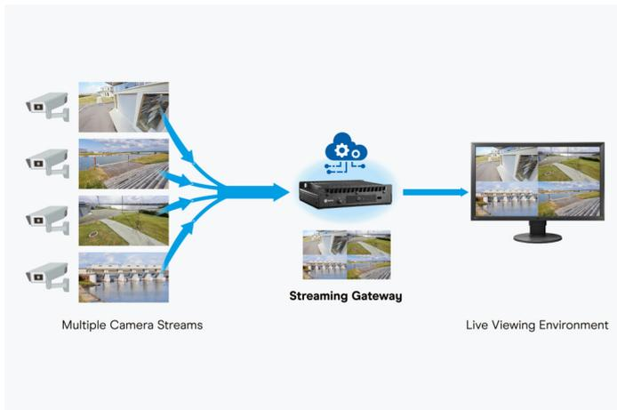
Der Merge-Modus unterstützt bis zu 32 Kameraströme.
