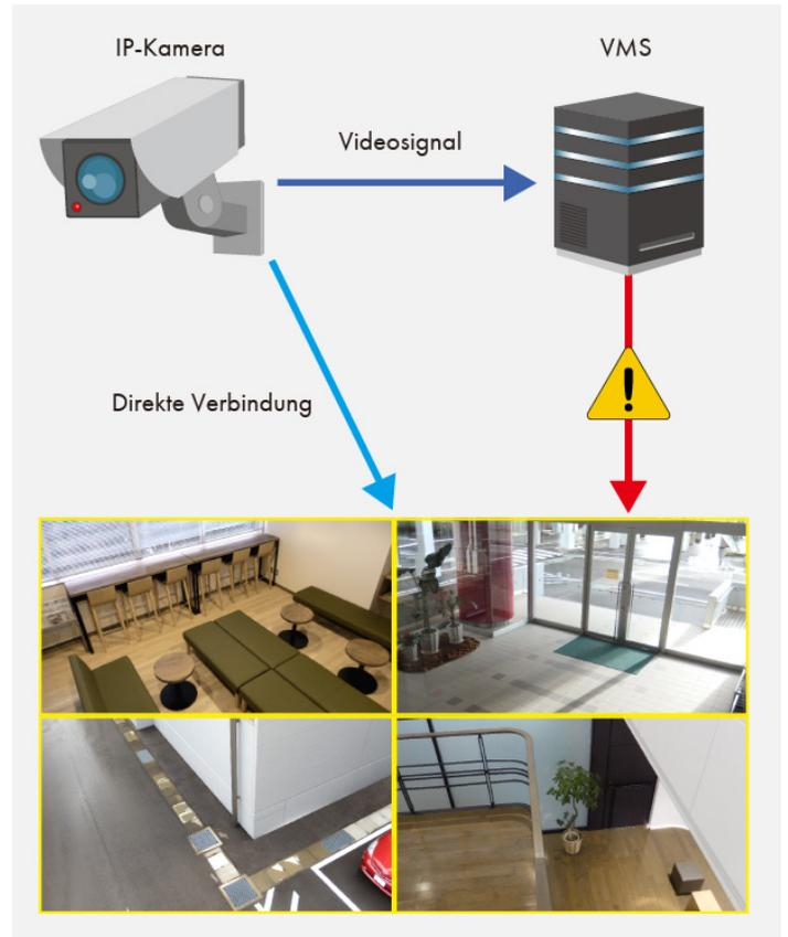
Mit VMS-Failover: Der Videostream wird weiterhin direkt von der IP-Kamera empfangen
